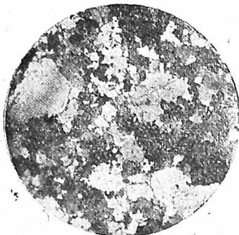
Фиг. 3. Кварцит падынский (Сегозеро). Никели скрещены. Увеличено в 25 раз. Хорошо выражен зубчатый характер сочетания зерен. В центре, на крупном зерне кварца видна вторичная оторочка
