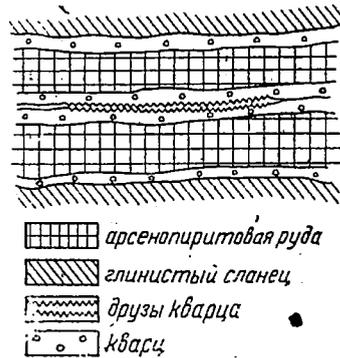
Фиг. 6. Схема строения рудной жилы
