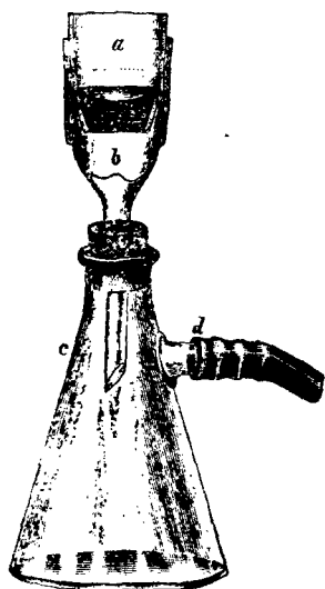
Рис. 38. Азбестовый тигель-фильтръ Гуча: а) фарфоровый или платиновый тигель; б) воронка, въ которую плотно вставленъ тигель съ помощью каучуковаго кольца; с) колба для фильтрованія подъ уменьшеннымъ давленіемъ; д) отростокъ, соединяющійся съ водян. насосомъ.
