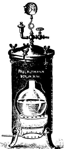
Рис. 83. Стерилизаторъ перегрѣтымъ паромъ (Папиновъ котель, автоклавъ).
