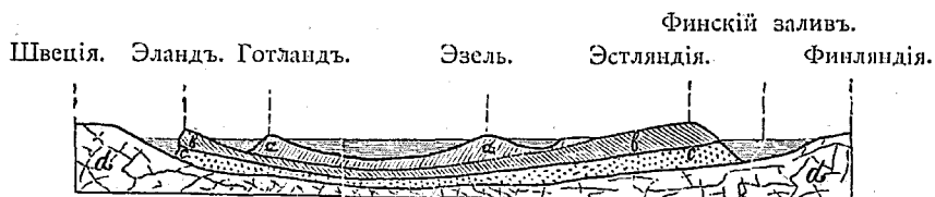
Фиг. 45. Разрѣзъ силурійскихъ образованій отъ береговъ Швеціи въ Эстляндію. d—лаврентьевская система, c—кембріійскія образованія, b—нижне-силурійскія, a—верхне-силурійскія.
