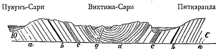
Фиг. 4. Разрѣзъ лаврентьевскихъ образований въ восточной Финляндіи (Пузыревскій): а—красный гнейсъ, б—сѣрый гнейсъ, с—роговообманковая порода, d—породы верхняго отдѣла, g—жила пегматита.
