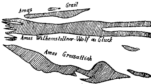
Фиг. 64. Мѣсторожденія мѣдныхъ рудъ въ Шмольницѣ, по Берн. фонъ Котта. А—черный глинистый сланецъ, В—сѣрый гл. сл., NS—подверевельный поясъ, LK—надпочвенный поясъ, EK—энгельбернскій штокъ, VV—сбросъ.
