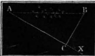
РѢШЕНІЕ I. Провѣшивъ линію  $AX$  (Фиг. 83) и опустивъ на нее изъ В перпендикуляръ  $BC$ , измѣряютъ цѣпью линіи  $AC$  и  $BC$ ; тогда  $AB = \sqrt{AC^2 + BC^2}$ .
