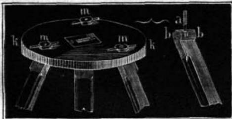
черезъ ушко другаго болта *a*. Болты *a* пропускаются чрезъ отверстія, сдѣланныя въ доскѣ *k*; верхняя ихъ часть наръзана винтомъ для того, чтобы на нее можно было навинчивать гайку *m*. Закрѣпляя эти гайки, ножки прижимаются верхними своими частями къ углубленіямъ доски и слѣдовательно дѣлаются неподвижными; ослабленіемъ гаекъ, ножки могутъ вращаться на болтахъ *bb*. Описанный штативъ изобрѣтенецъ мюнхенскимъ механикомъ Рейхенбахомъ.
