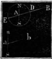
меридіана (Фиг. 143). Азимуть  $NAB$  измѣряется дугою  $ES = \cup DN$ , а потому принято наносить градусную величину азимутовъ отъ точки  $n$  вправо, т. е. отъ сѣвера къ востоку; дѣйствительно построивъ уголъ  $nab$  равный  $EAS$ , замѣчаемъ, что прямая  $ab$  имѣетъ относительно  $ns$  такое-же положеніе, какое имѣетъ линія  $AB$  относительно магнитнаго меридіана  $NS$ . Если азимуть болѣе  $180^\circ$
