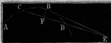
дикуляръ BF, и провѣшиваютъ линію BE, которая означаетъ достаточно вѣрное направление касательной.
