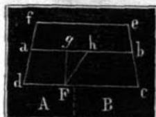
Черезъ произвольно взятую точку F проводятъ прямую Fg до пересѣченія съ прямой  $ab$ , и вычисляютъ площадь  $Fgbc = k$  десятинамъ; также опредѣляютъ площадь  $abef$ .
