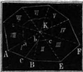
АКВ —  $aKb = AaBb$ , ВКЕ —  $bKc = bсЕВ$ , складываютъ  $AaBb + bсЕВ + \dots = I + II + III + \dots = S$ ; частное s, происшедшее отъ дѣленія суммы S на число n частей, опредѣлить площадь каждой части. Положимъ, что АК представляетъ первую линію раздѣла, и что
