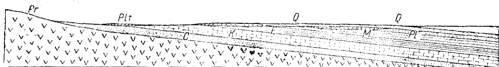
Рис. 102. Разрез атлантического берега Сев. Америки. Pr — протерозой и триас; C — нижний мел (потомак), K — верхний мел; третичные: E — эоцен, M — миоцен, Pl — плиоцен, Q — четвертичные.
