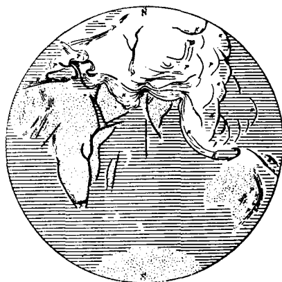
Фиг. 44. — Тектоническая схема восточного полушария. Тонкие линии—складчатые системы; толстые—разломы. Пунктиром показаны южные материковые массивы.
