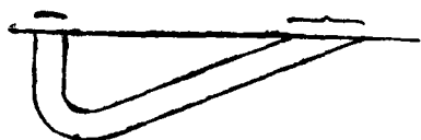
Фиг. 161. Ложное различие мощности пласта, на выходах обусловленное разным залеганием его.
