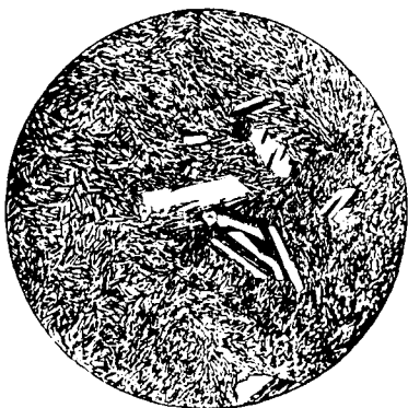
Фиг. 22.—Порфириовидная структура; фенокристаллы плагиоклаза в микролитовой массе флюидального сложения.
