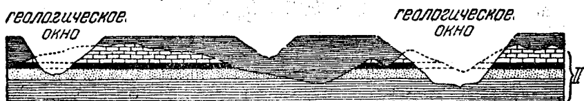
Рис. 119. Геологические окна происходят вследствие эрозии и позволяют видеть нижние свиты. Восстановите ход геологической истории данного места.
