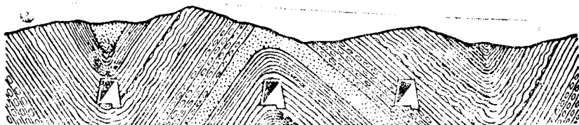
Рис. 63. Давление в ядрах синклиналей больше, чем в антиклиналях. Какую разницу в характере давления на крепь можно предвидеть в обоих случаях, т. е. какие части крепи будут разрушаться в том и другом случае?
