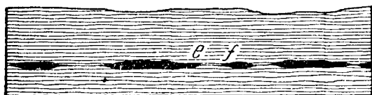
Рис. 12. Чечевицеобразное залегание. Между e и f выклинивание, исчезновение рудной линзы.
