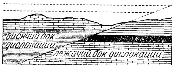
Рис. 10. Пласты лежащего статиграфически бока после дислокации являются висячим боком черного пласта (например, угольного).
