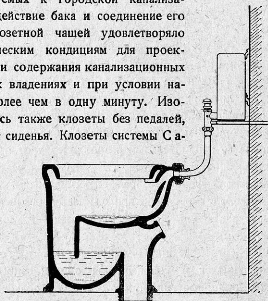
Фиг. 99. Установка аппарата „Звезда“.
