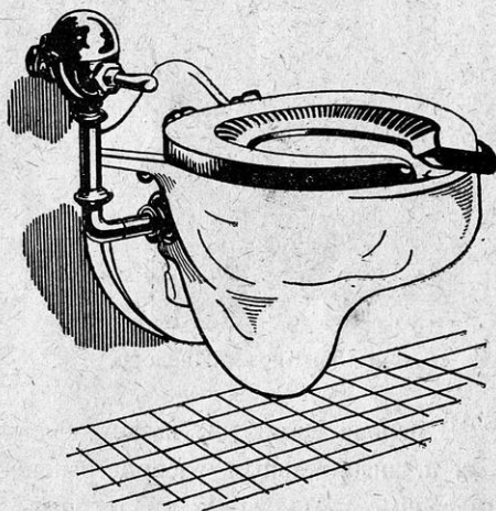
Фиг. 54. Клозет консольного типа.
