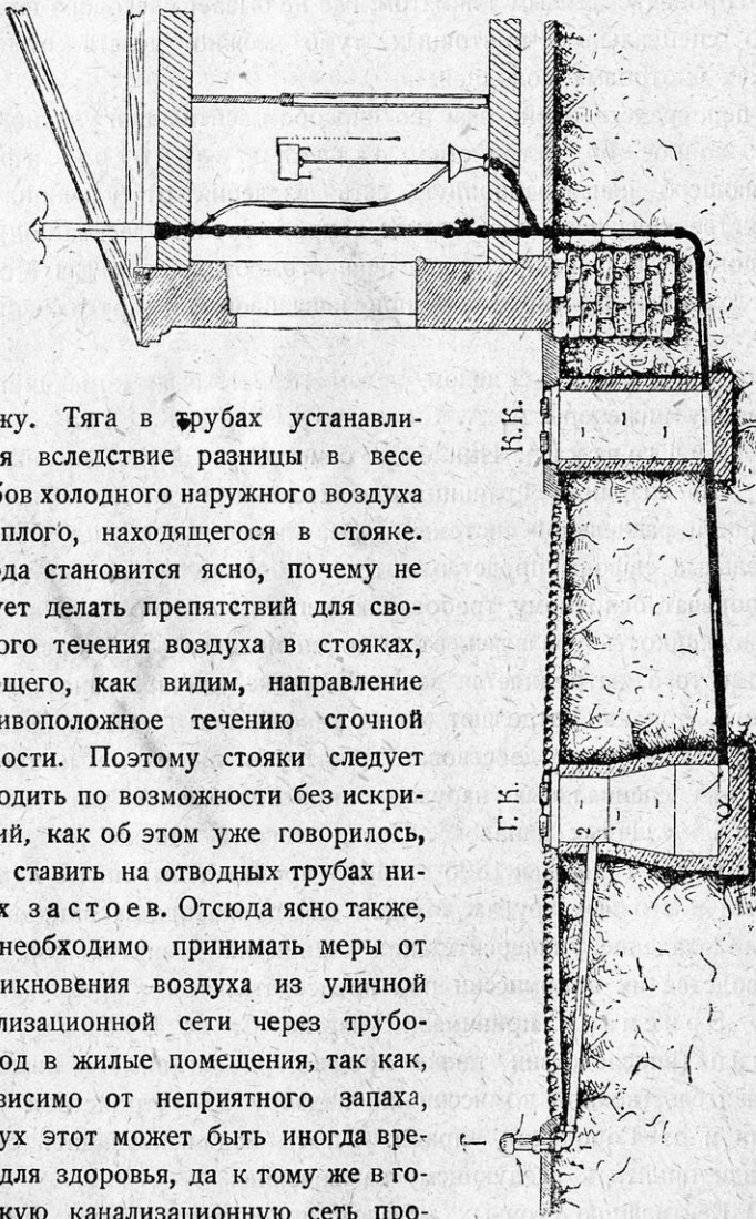
Фиг. 28. Вентиляция канализационной сети.
