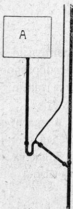
Фиг. 95. Присоединение автоматического бака к стояку.
