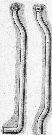
Фиг. 83. Трубы срывочные.
