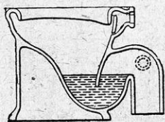
Фиг. 51. Воронкообразный клозет.
