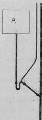
Фиг. 80. Присоединение автоматического бака к стояку
