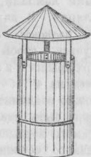
Фиг. 26. Колпак для вытяжной трубы.
