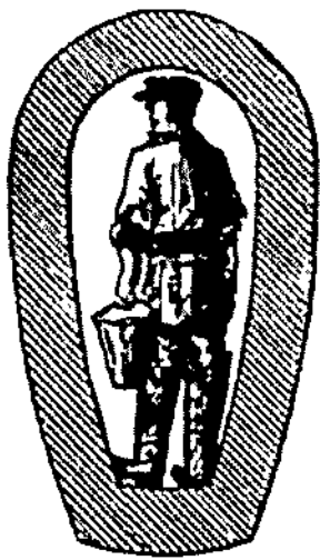
Черт. 660.—Характеристика желательных наименьших размеров коллекторов овального типа.
