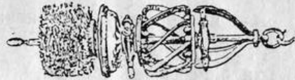
Черт. 446. — Приборъ для очистки трубъ отъ наростовъ. Приборъ вводится въ трубу и, образуя поршень, движется подъ давленіемъ воды, которая сообщаетъ ему еще вращательное движеніе. Скребки, расположенныя по винтовымъ линиямъ снимаютъ наросты и щетка очищаетъ стѣнки трубы.
