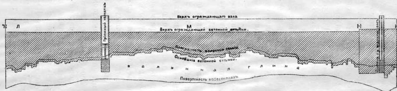
Черт. 356.—Спрявленная продольная профиль ограждающаго вала и внутренней бетонной стѣнки, сдѣланная по оси послѣдней. (Масштабъ длины: 0,01 саж. = 40 саж.; масштабъ высоты: 0,01 саж. = 2 саж.).
