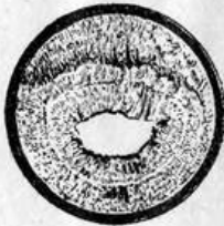
Черт. 445. — Видъ чугунной трубы, на внутреннихъ стѣнкахъ которой образовался наростъ изъ ржавчины и осадковъ солей.
