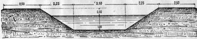
Черт. 464. — Профиль Уркскаго канала въ Парижѣ съ земляными откосами.
